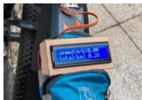
图5 LCD液晶屏显示实时运动速度和总里程
