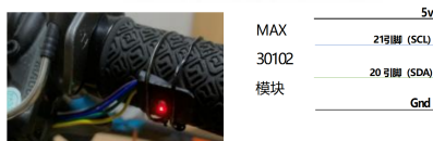
图4 血氧传感器的结构、测量原理及安装位置
