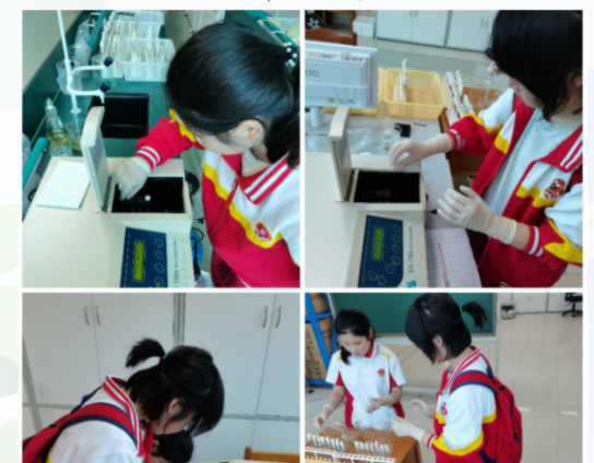
图 20 使用紫外分光光度计测定样品 OD 值
