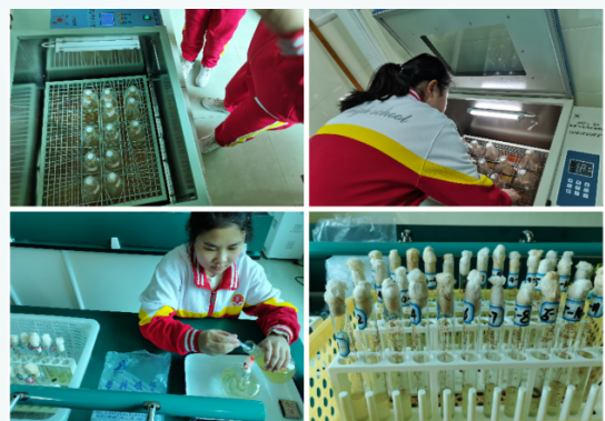
图 19 每培养两个小时取样到标记号的试管中，便于检测样品 OD 值
